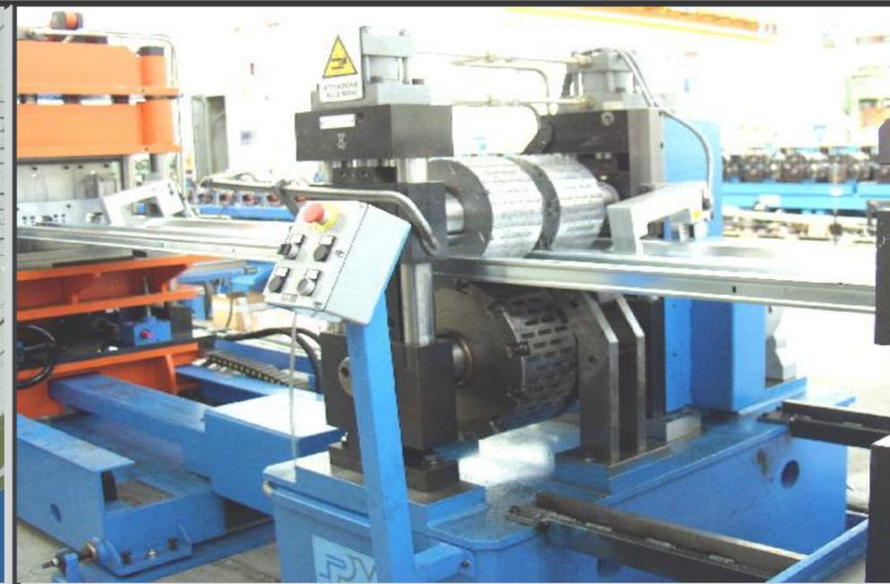
DETTAGLIO TESTA DI NERVATURA A RULLI
