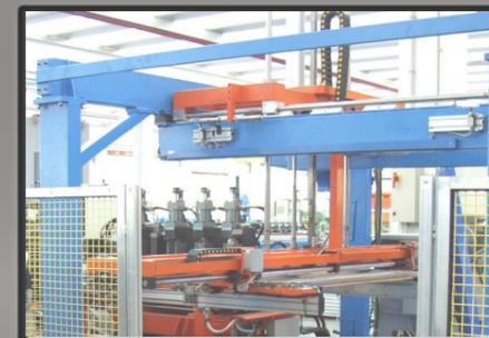
DETTAGLIO ZONA SCARICO E IMPILAMENTO
